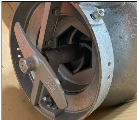
Justerbart snitsystem. Bottenvingen förhackar allt material innan det når pumphjulet som skär mot HARDOX-stål.
