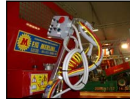
Elhydraulik för att reglera bottenmattan med styrbox inne i traktorn. (extra utr.)
