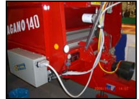
Elhydraulik för att reglera bottenmattan med styrbox inne i traktorn. (extra utr.)
