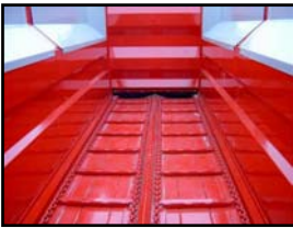
Dubbla bottenmattor i ankarkätting. Flakbotten i stålplåt.
