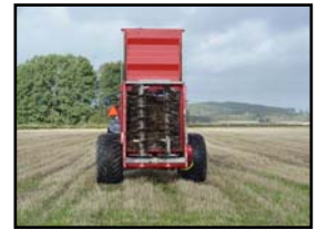
Hydraulisk bakläm med dubbla kolvar.
